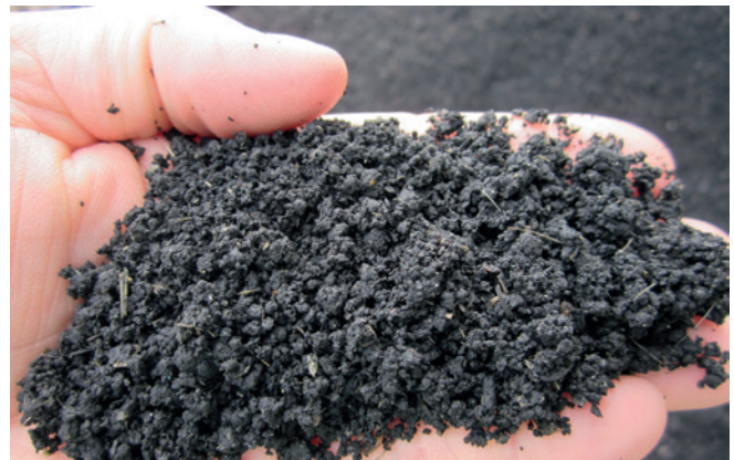
Abb. 7: Krümelige Struktur des thermisch desintegrierten, ausgefauten und über eine Zentrifuge entwässerten Faulschlammes
