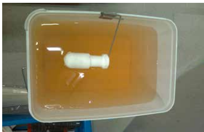
Spülwasserablauf eingefärbt durch roten Sandsteinschluff mit 20 % Partikelanteil kleiner 1µm
